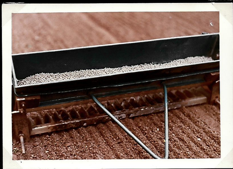
Granulált dohánymag vetése géppel. /Vetés sortávolsága 4 cm./
