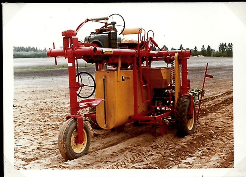
Balthes dohánykombajn, az ön- tözővíz és műtrágyatartállyal.
